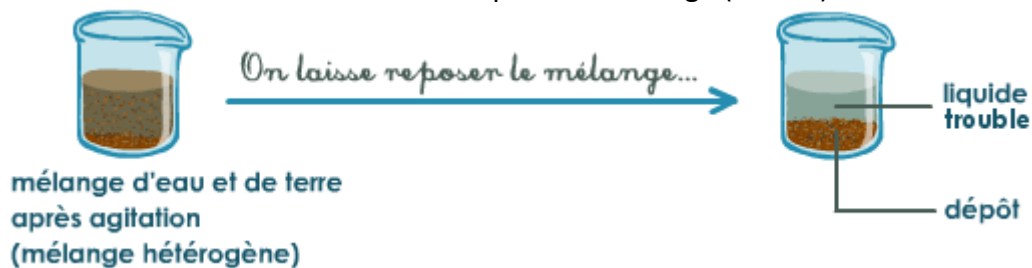
Doc. 1. Principe de la décantation.
