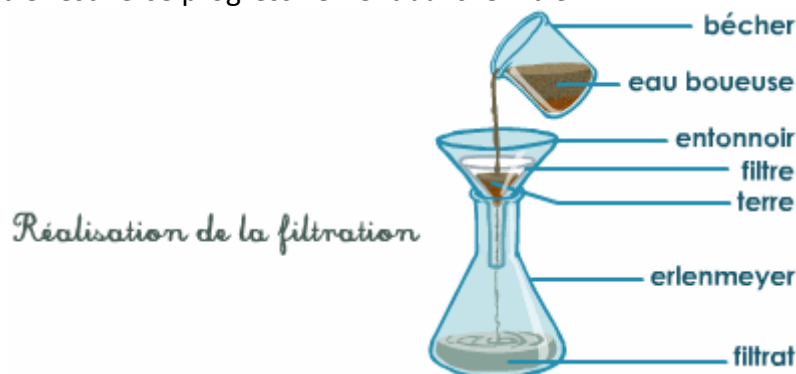
Doc. 3. Principe de la filtration.
