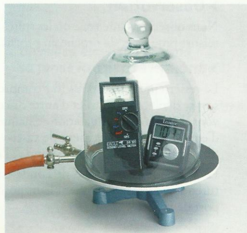
Doc. 9 Dispositif expérimental pour étudier la propagation du son.
