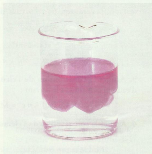
Doc. 4 L'ajout de quelques gouttes de soude dans une solution incolore de phénolphtaléine provoque un changement de couleur immédiat : les réactions acido-basiques sont instantanées.
